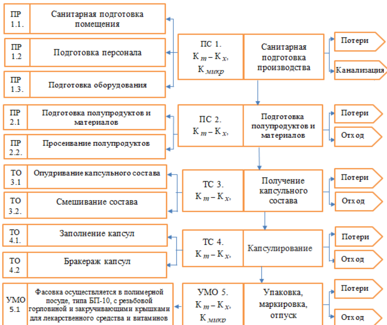
Рисунок 5. Технологическая схема производства капсулы «Дулونا-кард»
