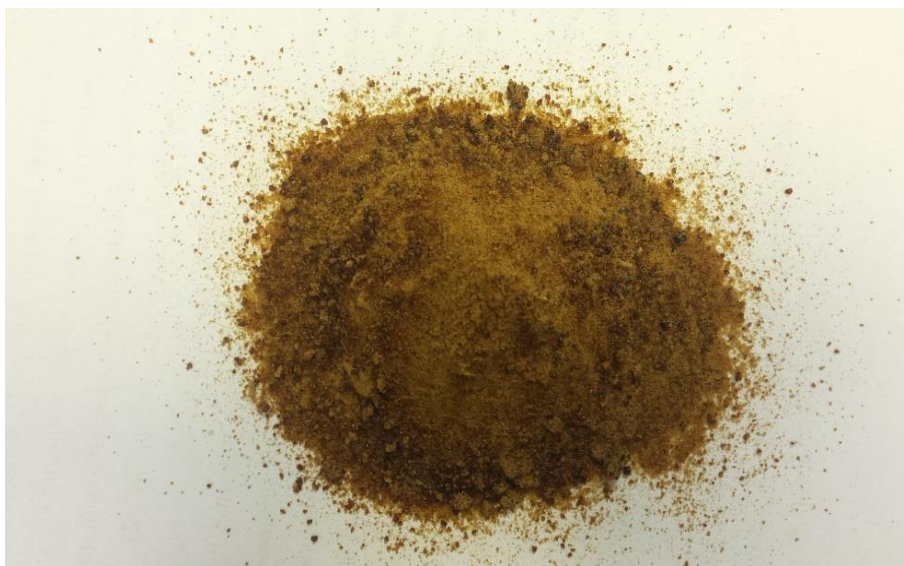
Рисунок. 3.5. – Сухой концентрат клубней топинамбура, полученный при сублимационной сушке
