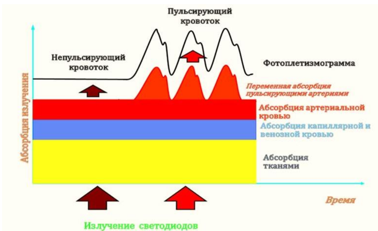
Рисунок 2.6. – Принцип работы светодиодных чрескожных пульсоксиметров
